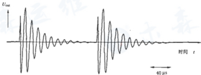
图 E1. c. 带宽 \Delta f=10\text{ kHz} , f_m=10\text{ kHz}
