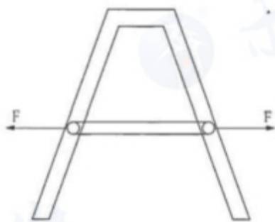
图C.14 人字梯限张装置强度试验示意图
