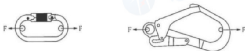
图C.5 连接器静负荷试验示意图
