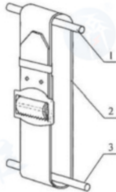
图 C.9 登杆脚扣静负荷试验示意图
