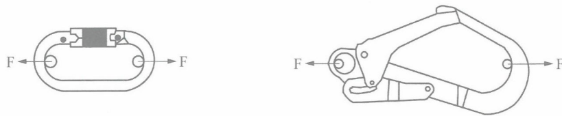
图 C.5 连接器静负荷试验示意图
